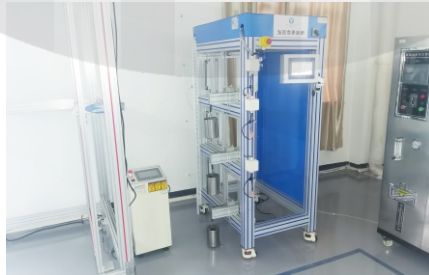
05. 电锁耐用测试设备 (意林500kg磁力锁通过100万次耐用测试)
